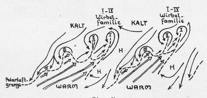
Figur V. Schema des Aufrollens der Polarfront in Tiefdruckwirbel-Familien (nach J. Bjerknes).
