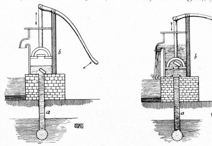
Abb. I. Wie eine Saugpumpe bei hochgehendem
