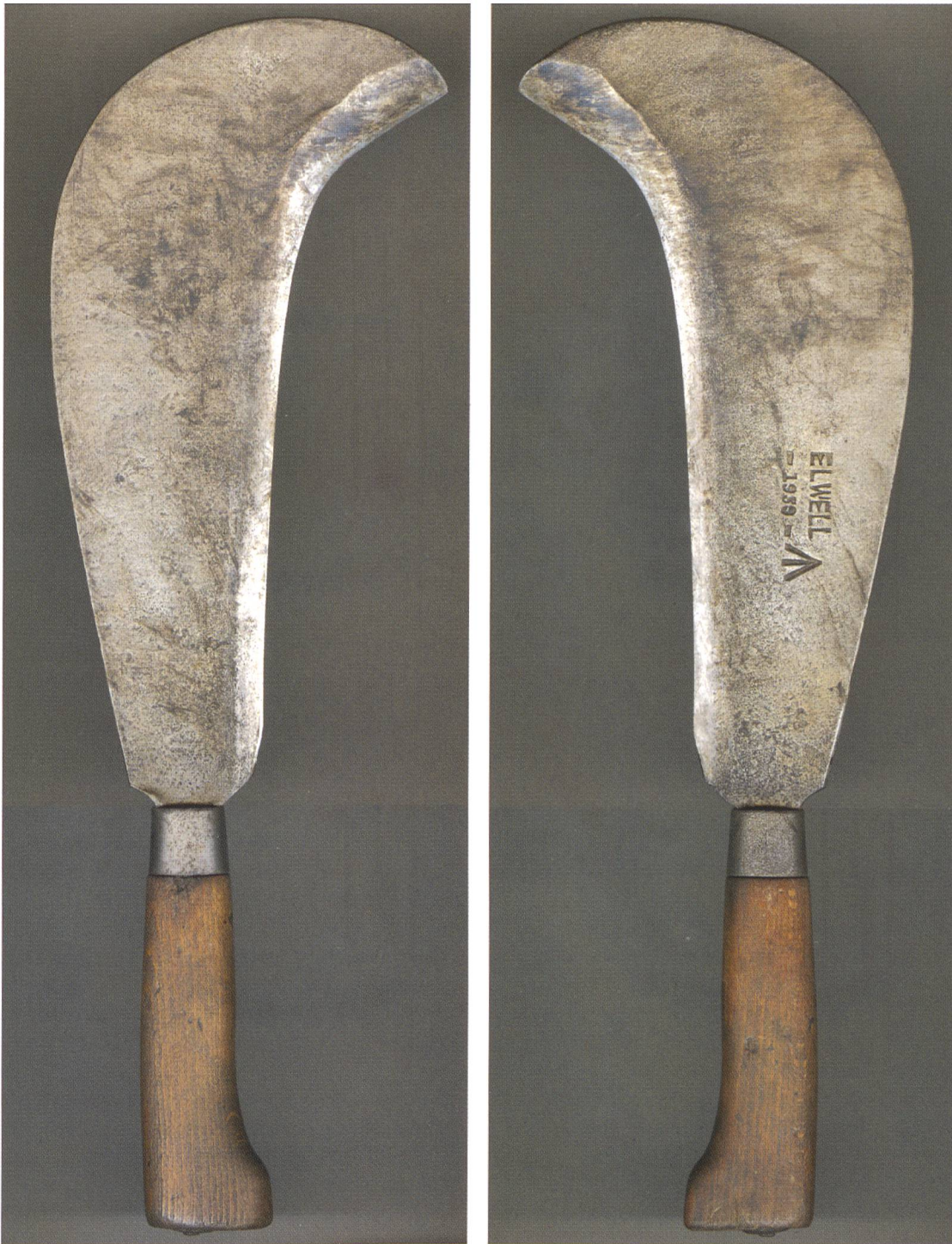
Abb. 4. Die beiden Seiten einer Schnitthappe/Heep mit einem Heft aus Treburer Privatbesitz. Die Schnitthappe ist mit Heft 40,8 cm, ihr Blatt 26,6 cm lang. Ihr Heft besteht aus Eichenholz. Gefertigt wurde diese Schnitthappe von einer Werkzeugschmiede namens ELWELL im Jahr 1939. Die Schmiedemarke darf man als eine Art Pfeilspitze bezeichnen. Foto: Armin Weber
