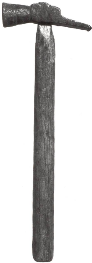
Abb. 9. Ein neuerer Bleihammer in Seitenansicht. Die Gesamtlänge seines Stieles beträgt 24,9 cm. Sein Arbeitsteil ist 83 mm hoch und die Finne 23 mm lang. Foto: Azzola
