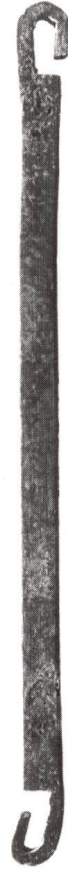
Abb. 12. Ein 22 cm langes Kröseleisen aus den Sammlungen des Germanischen Nationalmuseums Nürnberg, Inv. Nr. Z147. Foto: Germanisches Nationalmuseum Nürnberg
