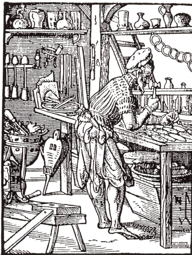
Abb. 2. Der Glaser nach Jost Amman, 1568. Mit seinem Bleihammer setzt er Bleinägel zum Fixieren der Butzenscheiben. Reproduktion
