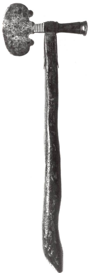
Abb. 3. Ein Bleihammer in Seitenansicht. Der Stiel ist 37,8 cm lang, das Arbeitsteil des Hammers 127 mm hoch und der Halbmond maximal 79 mm breit. Foto: Azzola
