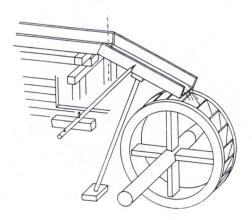
Abb. 3: Skizze eines oberschlächtigen Wasserrades mit dem zugehörigen Zulauf nach Herbert Jüttemann<sup>3</sup>. Reproduktion
