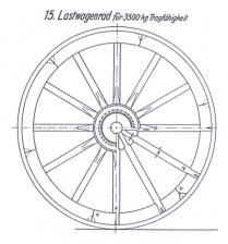
Abb. 2: Reproduktion der Zeichnung eines Lastwagenrades von Otto Koebke: Werkkunde des Stellmachers und Karosseriebauers. Hamburg 1950, S. 180.
