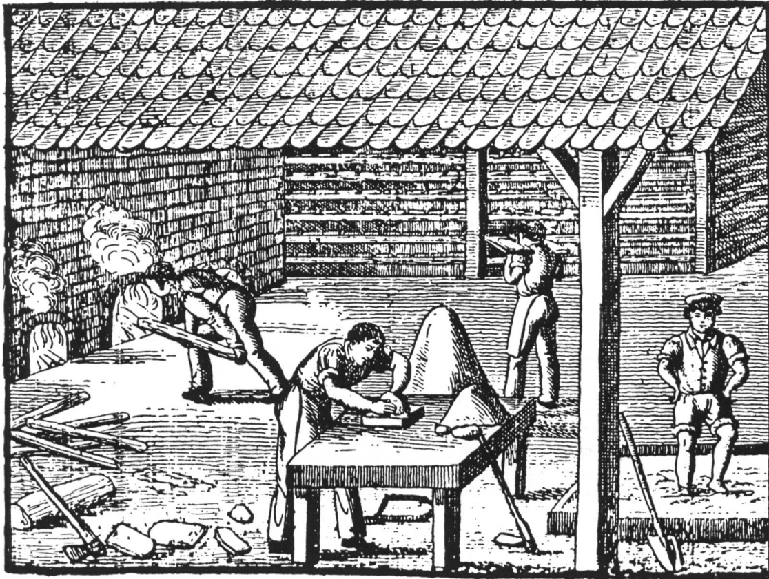
Fig. 43 Tuilerie vers 1835. Gravure extraite de J. E. Gailer, NEUER ORBIS PICTUS FÜR DIE JUGEND , Reutlingen 1835. On distingue de droite à gauche: la préparation de l'argile par foulage, la confection de briques à l'aide d'un moule rectangulaire sur une table saupoudrée de sable (au sol, sous la table, un gabarit à tuiles plates), le transport des tuiles sur des planchettes vers le séchoir et le four.
