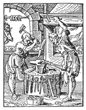
Fig. 47 Le maréchal-ferrant, gravure de Jost Amman, parue en 1568. On distingue à l'arrière-plan l'extrémité du bras servant à actionner le soufflet de la forge. Le maréchal et son aide forgent à deux, le marteau de l'aide étant beaucoup plus lourd. A terre, un boutoir, des clous et une caisse à petit outillage. Le marteau arrache-clous, (fendu) est retenu par un anneau au bout d'une chaîne sans doute fixée à la ceinture. La tenaille est maintenue fermée à l'aide d'un crochet.
