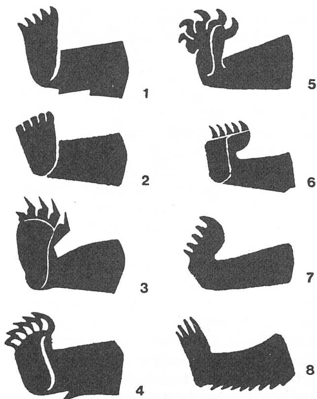
Abb. 6 Tatzformen. 1: Schwimmflossentatze. 2: Stumpfzehen- tatze. 3: Stilettkrallentatze. 4: Sägetatze. 5: Fräsen- segmenttatze. 6: Steigeisentatze. 7: Tricounitatze. 8: Fran- senfusstatze.
