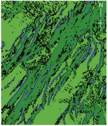
Abb. 2: Ramosch 2023. Beispiel für die teilautomatisierte Analyse von LiDAR-Daten in GIS, in deren Rahmen das gesamte Gelände in zwei Klassen eingeteilt wird, woraus sich mögliche Terrassen ergeben. Hellgrün: eher flaches Gelände, dunkelgrün: stark geneigtes Gelände (ROFFLER 2020). Zum Vergleich rechts in blau: photogrammetrisch kartierte Terrassenkanten (RABA 1996). Zur Lage im Untersuchungsgebiet siehe weisses Rechteck in Abb. 1.
