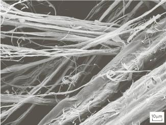
spaltbar. Asbest galt deshalb bis in jüngste Zeit vor allem im Bau als unverzichtbarer Stoff. Historisch kann man seine Verwendung sehr weit zurückverfolgen. Es gibt einerseits die überlieferte direkte Verarbeitung zu einem Gewebe Textil oder einer Schnur, andererseits die Verwendung als Armierung von Keramik oder als Zugabe in der Wandmalerei.
