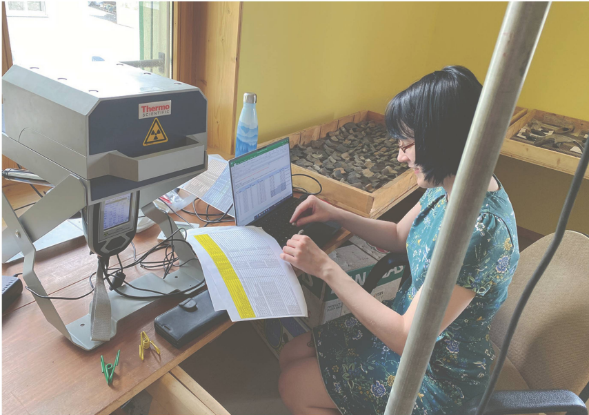
Abb. 2: Corina Gottardi bei den Messungen an den Scherben von der Mottata mit dem portablen XRF-Gerät.
