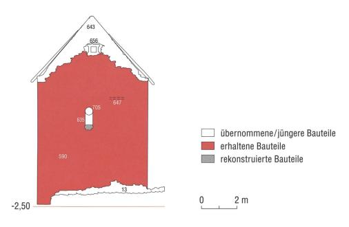
**Abb. 127:** Domat/Ems, Sogn Pieder. Anlage 2a. Kirche. Ostfassade (590) mit dem von Anlage 1 übernommenen Mauerteil (13) und der barocken Aufmauerung (643). Zum originalen, karolingerzeitlichen Bestand gehört das Rundbogenfenster (635), welches in der Barockzeit zu einem Oculus (705) modifiziert worden ist. Einen Hinweis auf die Bauweise der Kirche liefert das Negativ (647) eines Armierungsbalkens. Das Fenster (656) ist in moderner Zeit eingebaut worden. Mst. 1:150.
