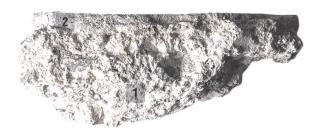
Abb. 152: Domat/Ems, Sogn Pieder. Anlage 2a. Kirche. Aufbau des Wandverputzes der Gruppe 1: 1 Grundputz mit dünner Kalktünche, darauf der 2 3 mm starke Feinputz mit roter Malerei (vgl. Abb. 151.1).
