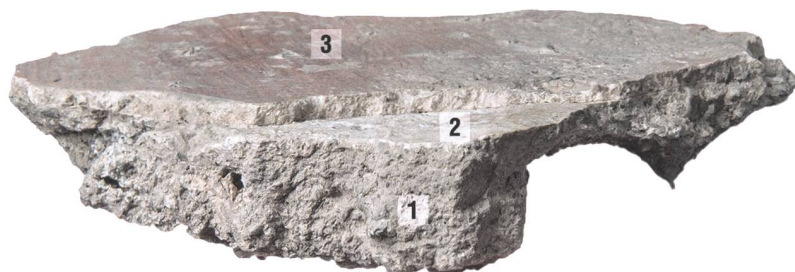
Abb. 66: Domat/Ems, Sogn Pieder. Anlage 1. Verputzfragment. 1 Grundputz; 2 dünne Kalktünche; 3 3 mm starker Malputz mit roter Bemalung.
