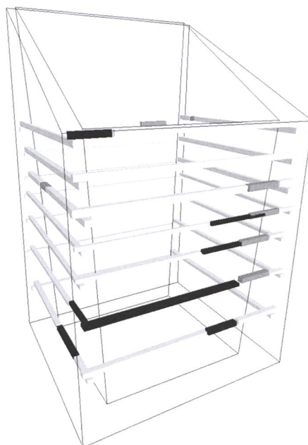
Abb. 138: Müstair. Kloster St. Johann. Plantaturm. Schematische Darstellung der stockwerkartig verbauten, mit der Dendrochronologie ins Jahr 960 datierten Ankerbalken im Mauerwerk.
