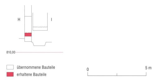
**Abb. 332:** Tomils, Sogn Murezi. Anlage 4b vor dem Abbruch. Schnitt A-A (vgl. **Abb. 330**) mit den zugemauerten Eingängen von Raum H und G sowie der Grube (1109) in der Nordostecke des Hofes I. Blick nach Osten. Mst. 1:100.
