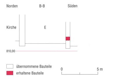
**Abb. 323:** Tomils, Sogn Murezi. Anlage 4b. Schnitt B-B (vgl. **Abb. 314**) durch den Südannex E mit erneuerter Südmauer (1026). Blick nach Osten. Mst. 1:150.
