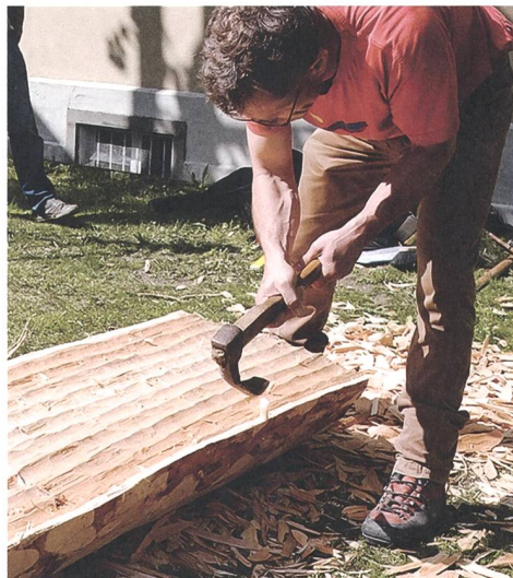
Abb. 90: Chur, Experiment, 26. April 2014. Mathias Seifert mit modernem Dechsel an einer Halbholtzbreitseite.
