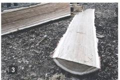
hölzer keine rechtwinklig planen, sondern verdrehte Oberflächen aufweisen. Grundsätzlich dürfte das Abspalten der Schwarte weniger zeitintensiv sein als die davor beschriebene Methode. Die Querschnitte der St. Moritzer Bohlen bilden mehrheitlich Halb-, in zwei Fällen Viertelhölzer ab Abb. 88.
