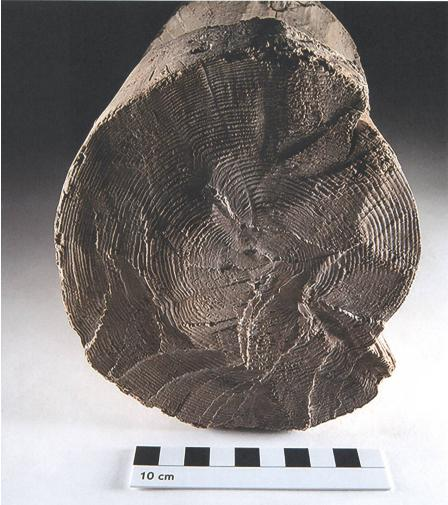
die Röhren 1 und 2 aus demselben Baum gewonnen wurden. Das ähnliche Jahrringbild deutet dennoch auf die Herstellung der beiden Röhren aus einem Stamm hin (Kap. 12.6.1). Durch die Zusammenführung der Massangaben – unter Berücksichtigung der Kürzung der Röhre 2 (1853) und einer Spaltkerbe im Horizontalschnitt von etwa 10 cm zwischen dem Wurzelende (Röhre 2) und dem höher liegenden Stammteil (Röhre 1) – erscheint es plausibel, dass es sich um einen Stamm gehandelt hat.<sup>208</sup>
