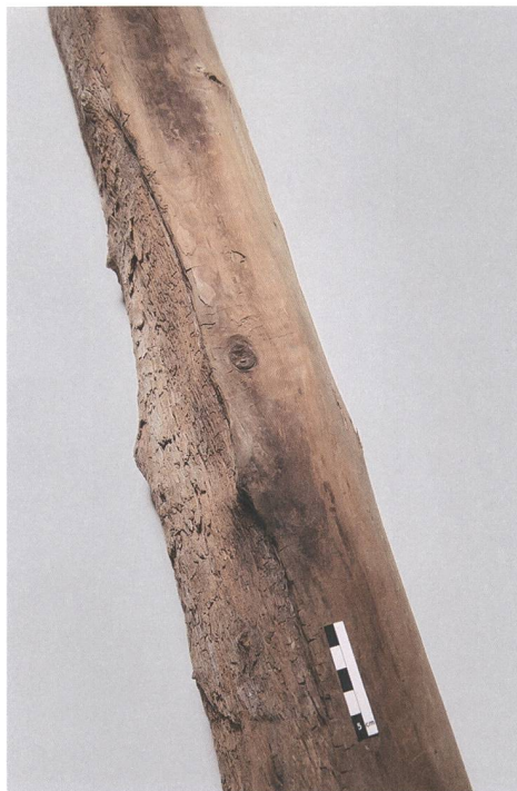
Abb. 19: St. Moritz-Bad, bronzezeitliche Quellfassung. Blockholz Nr. 1. Braunfäule mit charakteristischem Würfelbruch an der Aussenseite und intakt erhaltener Innenseite.
