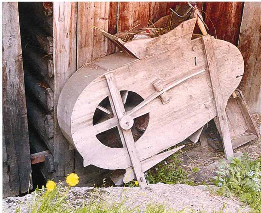
Abb. 9: Kappl/Paznaun (Österreich), sogenannte «Windmühle» zum Reinigen bzw. Abtrennen des gedroschenen Getreidekorns von den Spelzen (Foto: D. Reidl, 2011).
