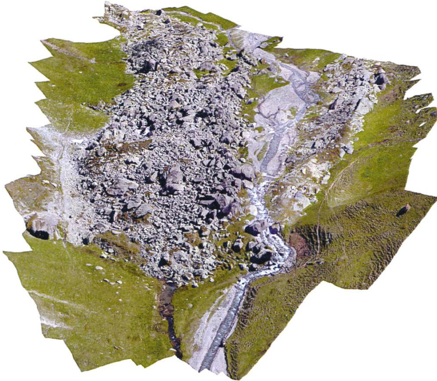
Abb. 8: Dreidimensionales Geländemodell von Plan da Mattun, erstellt auf Basis von mehreren hundert UAV-Bildern; Juni 2011 (Screenshot D. Grimm/ETH Zürich).
