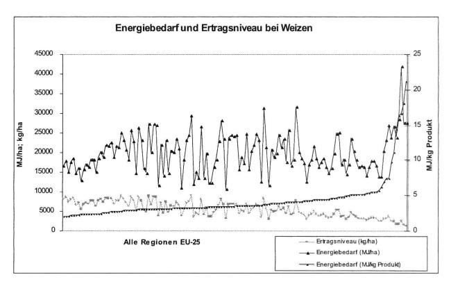
Abb. 3: Energiebedarf je Hektar sowie je Kilogramm Produkt und Ertragsniveau bei Weizen (alle Standorte EU-25).
