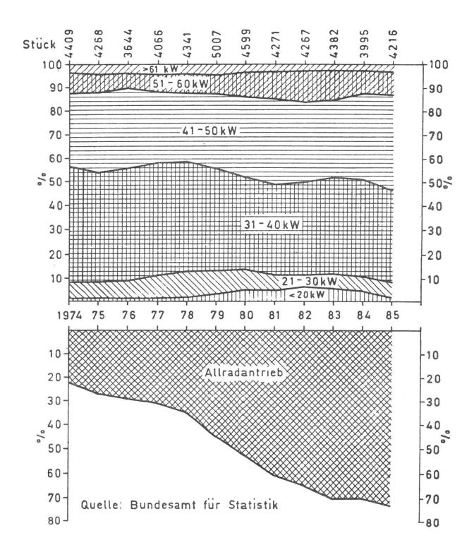
Abb. 7: Neu in Verkehr gesetzte Traktoren, gruppiert nach Leistung bzw. Allradantrieb, 1974 - 1985
