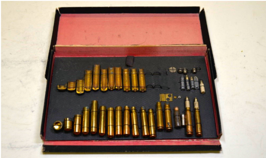
Panoplie didactique qui documente les différentes phases de fabrication d'une cartouche pour fusil mpd. 1889. Inv. MAHF 2019-144. © Musée d'art et d'histoire Fribourg (Denis Decrausaz).
