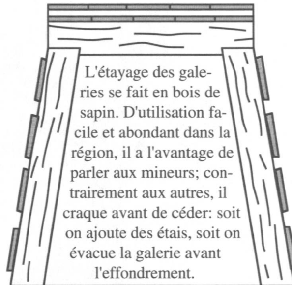
Profil d'étagage dans une galerie de fond
