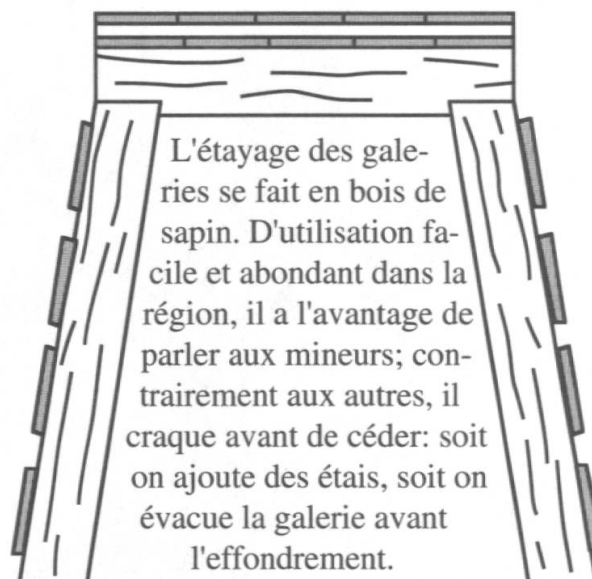
Profil d'étayage dans une galerie de fond
