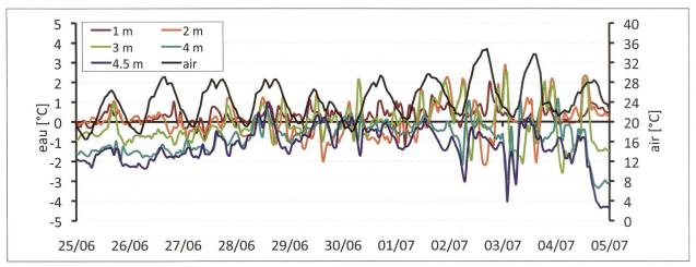
Fig. 6. Effets thermiques du rejet à différentes profondeurs par rapport à une colonne de référence située quelques centaines de mètres en amont; semaine typique en 2010, données horaires (Viquerat 2012).
