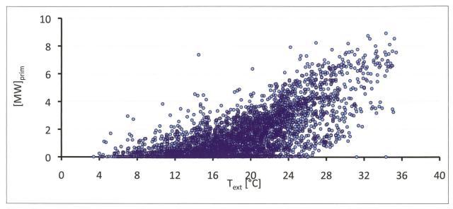
Fig. 4. Signature de la puissance de froid du réseau; données horaires du 1er avril 2010 au 31 mars 2011 (Viquerat 2012).
