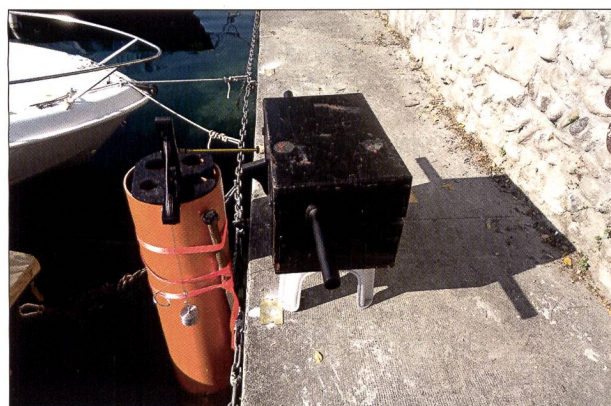
Fig. 11. Le limnigraphe en test dans le lac, © MHS.
