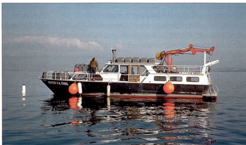
Fig. 2. « La Licorne », bateau de recherche de l'Institut F.-A. Forel est basé sur le Léman. Ce bateau est équipé d'une grue hydraulique permettant la mise à l'eau d'équipements lourds de mesure et d'échantillonnage (carottier, bouteille de prélèvement, flûtes sismiques). Il peut accueillir jusqu'à 12 personnes. (photo J.-L. Loizeau)
