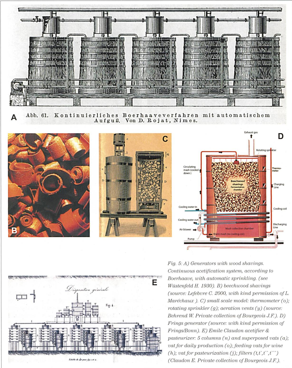
**A** Abb. 61. Kontinuierliches Boerhaaveverfahren mit automatischem Aufgüß. Von D. Rojat, Nimes.
