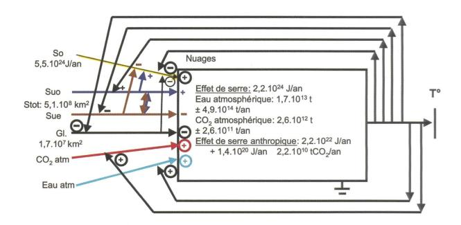
Fig. 3: Régulation climatique physique, chimique, géologique: en tendance thermique (interactions et feedbacks positifs: zéro ou infini. +.+=+; -.-=+). So: constante solaire (1/4). Suo: surface des océans. Sue: surface terrestre émergée. Gl: surface de glace.  $CO_2$  atm: gaz carbonique atmosphérique. Eau atm: vapeur d'eau. T°: température moyenne.  $\overline{-}$ : perte thermodynamique (entropie).
