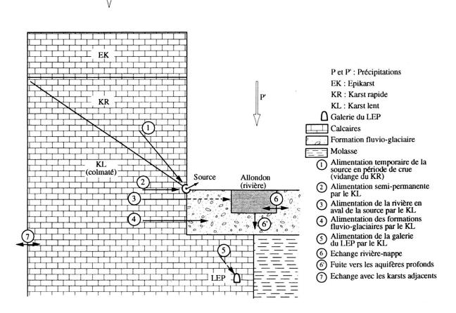
Fig. 2. Modèle de fonctionnement du système aquifère de l'Allondon
