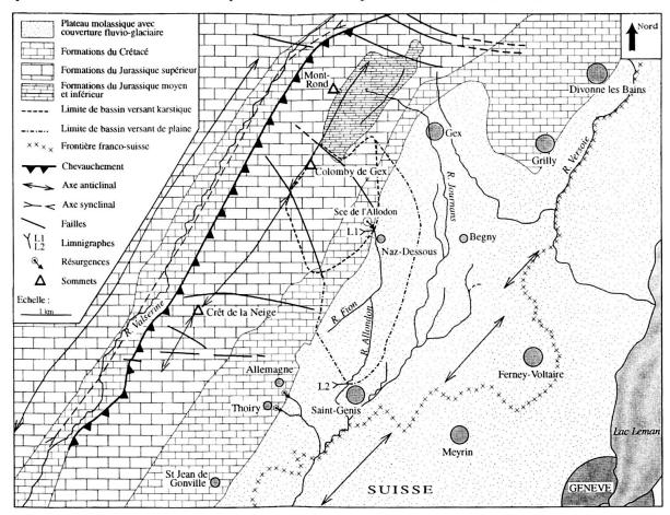
Fig. 1. Plan de situation avec géologie simplifiée
