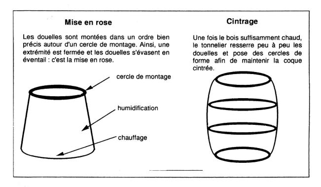
Fig. 4. Mise en rose et cintrage d'une barrique.
