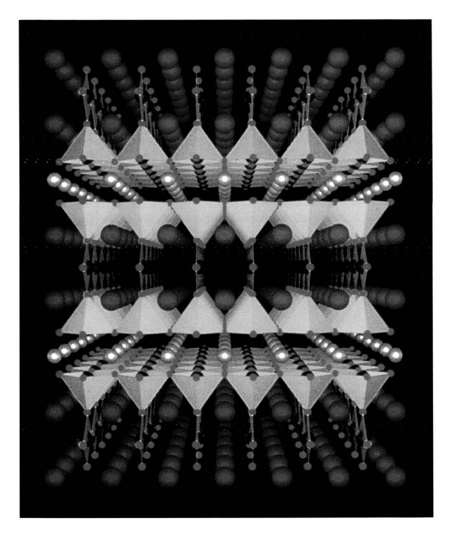
Structure de Y Ba<sub>2</sub> Cu<sub>3</sub> O<sub>7</sub>
