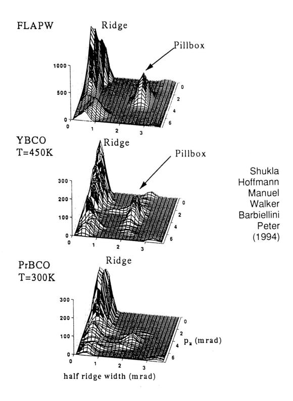
$\label{eq:Fig. 14} \text{Surface de Fermi dans Y $Ba_2Cu_3O_7$ et $Pr$ $Ba_2Cu_3O_7$ par $ACAR$}$
