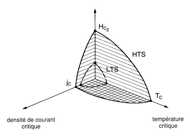
$\label{eq:Fig.6} Fig.~6$  Diagramme de phase Champ - Courant- Température
