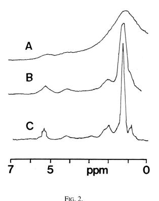
Spectres R.M.N.: A) Graines de moutarde intactes. B) Graines de moutarde entourées par le CCl4. C) Huile extraite de graines de moutarde.
