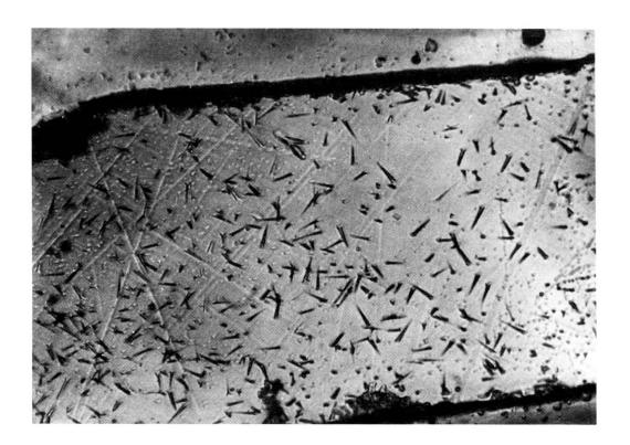
$\label{eq:Fig.3} Fig. \ 3.$  Vue agrandie de la photo  $N^\circ$  1 montrant l'allure conique des traces.
