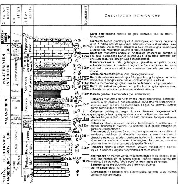
Fig. 2. — Coupe lithostratigraphique synthétique des terrains crétacés affleurant dans la partie septentrionale de la Montagne du Vuache.
