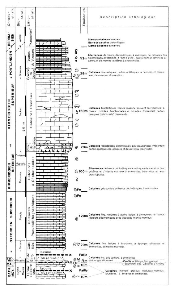
Fig. 1. — Coupe lithostratigraphique synthétique des terrains jurassiques affleurant dans la partie septentrionale de la Montagne du Vuache.
