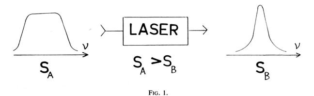
Le laser peut servir comme un modèle pour la création de la néguentropie. Le rayonnement à l'entrée, caractérisé par une bande spectrale large est 'incohérent', tandis que le rayonnement à la sortie est 'cohérent', avec une bande spectrale étroite. Par conséquent, la différence des entropies  $(S_B-S_A)$  est négative.
