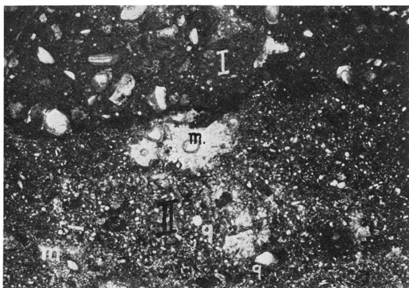
FIG. 4. — Croûte calcaire polyphasée (D-291c). Grossissement X14. Phase I: micrite emprisonnant de nombreux fragments de calcaire urgonien. Phase II micrite farcie de prismes brisés de microcodiums, contient également quelques colonies démantelées de microcodiums ( m ) et du quartz détritique ( q ).
