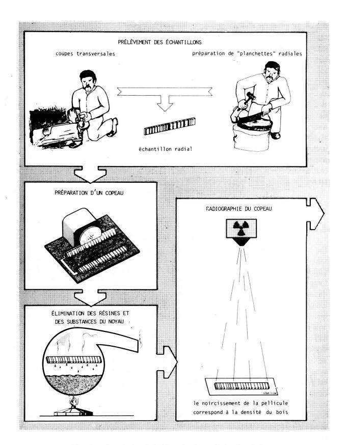
Fig. 4. — Le principe de la détermination radiodensitométrique.
