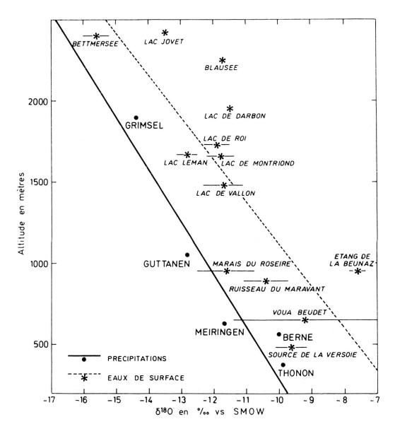
Fig. 3. — Teneurs moyennes en <sup>18</sup>O dans les précipitations en fonction de l'altitude des stations et dans les eaux de surface en fonction de l'altitude moyenne du bassin versant.
