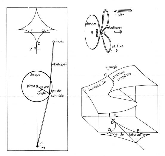
Fig. 2. — Machine à catastrophes de Zeeman.
