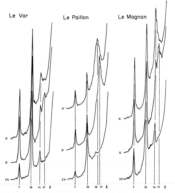
Fig. 3. — Diffractogrammes des sédiments des fleuves côtiers.
