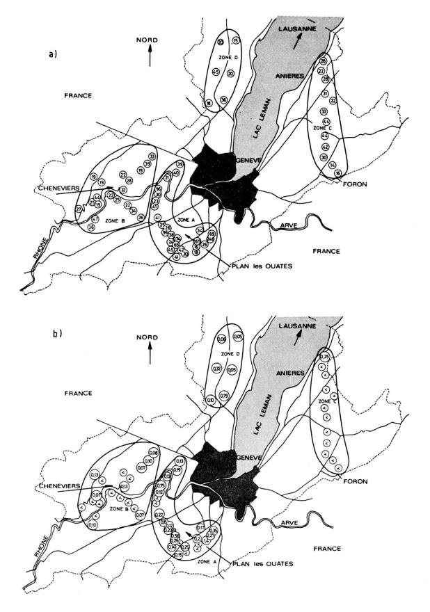
Fig. 1. — Répartition du plomb et du mercure dans les sols du bassin genevois: a. plomb (ppm); b. mercure (ppm). Limite de détection 0,05 ppm.
