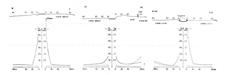
Fig. 2. — Répartitions types des concentrations de plomb et de mercure aux abords de l'autoroute Lausanne-Genève.
