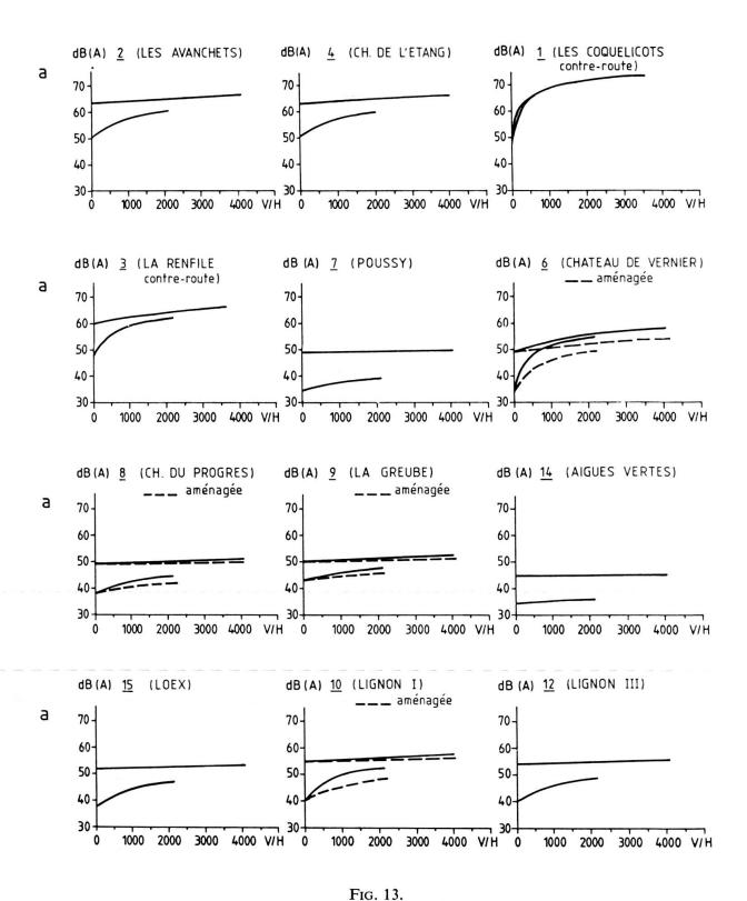
Niveaux sonores calculés  $L_{\text{éq}}$  (dB(A)) pour les variantes 1B et 6F: a. variante 1B; b. variante 6F (voir également fig. 16); c. points communs aux variantes 1B et 6F.
