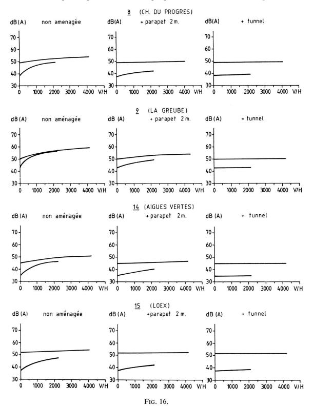
Variante 6F. Niveaux sonores calculés  $L_{\text{éq}}$  (dB(A)) avec deux types d'aménagement anti-bruit pour la traversée du Rhône: parapet et tunnel.
