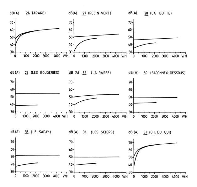
Fig. 19. Evitement de Plan-les-Ouates. Variante «Par le Val des Vaulx». Niveaux sonores calculés  $L_{\text{\'eq}}$  (dB(A)).
