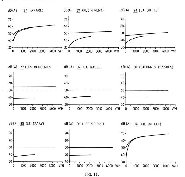
Evitement de Plan-les-Ouates. Variante « par le sud d'Arare ». Niveaux sonores calculés  $L_{\text{éq}}$  (dB(A)).
