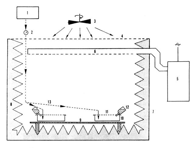
Fig. 1. — Coupe schématique de la chambre anéchoïque d'irradiation.
