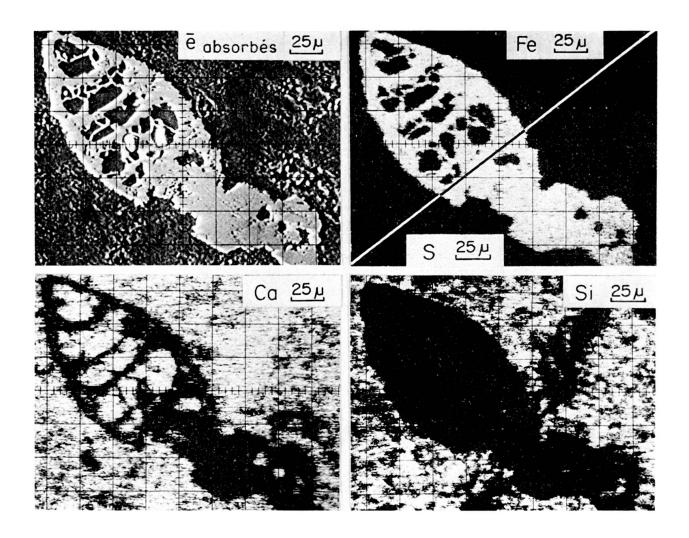
Fig. 5. — Concrétion minéralisée de type 2.
