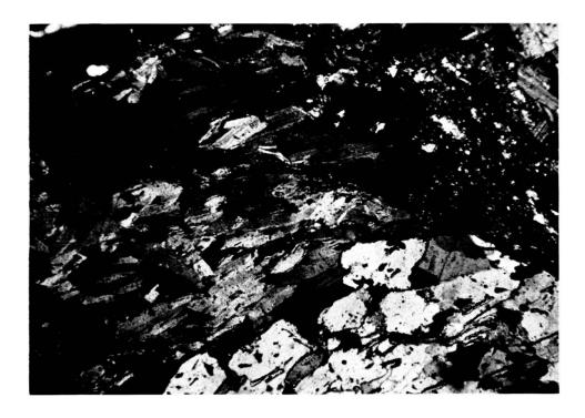
Fig. 8. —  $N^{o}$  36. Albitite chlorito-micacée à grenat. Lumière polarisée.  $G = 20 \times$ .
