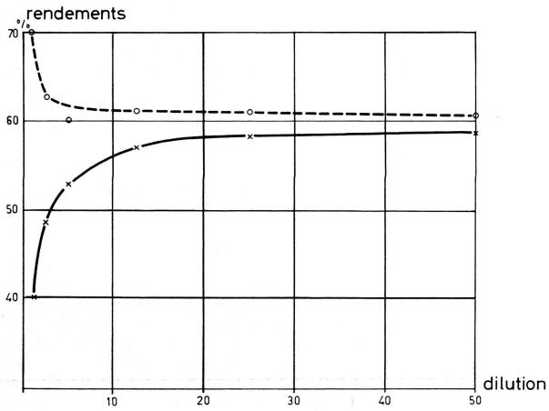
Fig. 1. — Variation des rendements théorique et pratique d'extraction en fonction de la dilution. o - - - - o Rendement théorique = N dans 20 ml de solvant en % N prise d'essai. x — x Rendement pratique = N dans x ml recueilli en % N prise d'essai.
