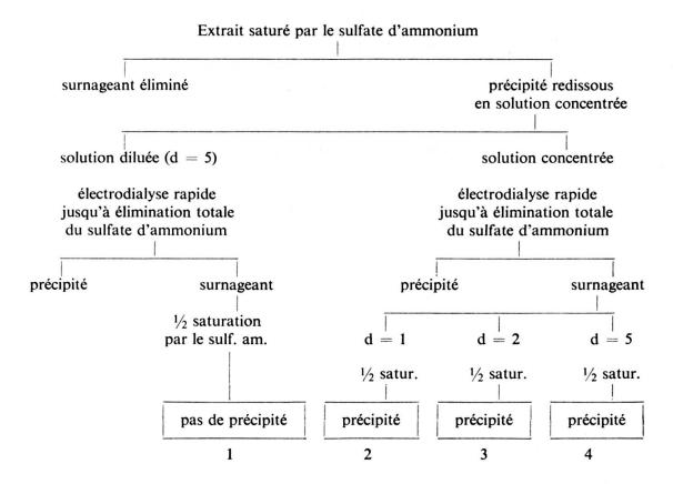
Au moment de la demi-saturation par le sulfate d'ammonium, les solutions des cas nos 1 et 4 présentent exactement la même concentration en protéines et en sulfate d'ammonium, or seule la solution no 4 donnera lieu à une précipitation.
