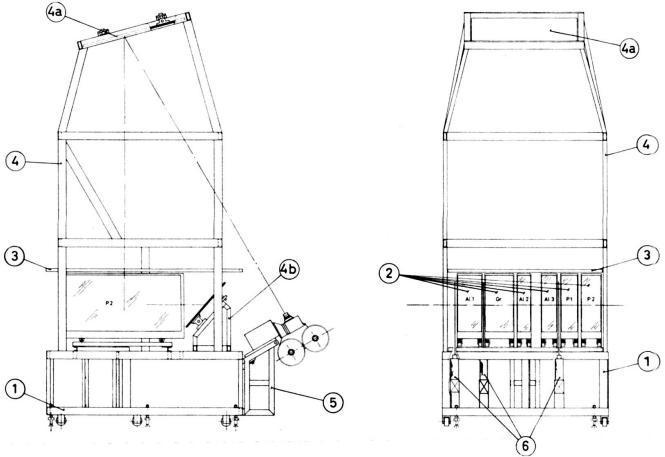
Fig. 2. — Vue d'ensemble du polarimètre.
