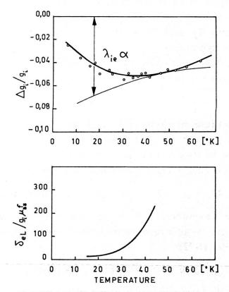
Fig. III-2. — Déplacement de raie de la résonance du Gd<sup>+++</sup> dans le La<sub>0,94</sub> Gd<sub>0,06</sub> Ru<sub>2</sub> et taux de relaxation des électrons vers le réseau.
