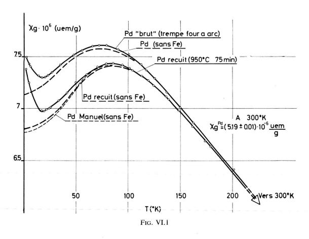
à basse température de sa susceptibilité. Comme le signale Dekhtyar, un tel recuit semble suffisant pour une recristallisation complète du métal et une élimination des lacunes et contraintes survenues au cours d'une trempe.
