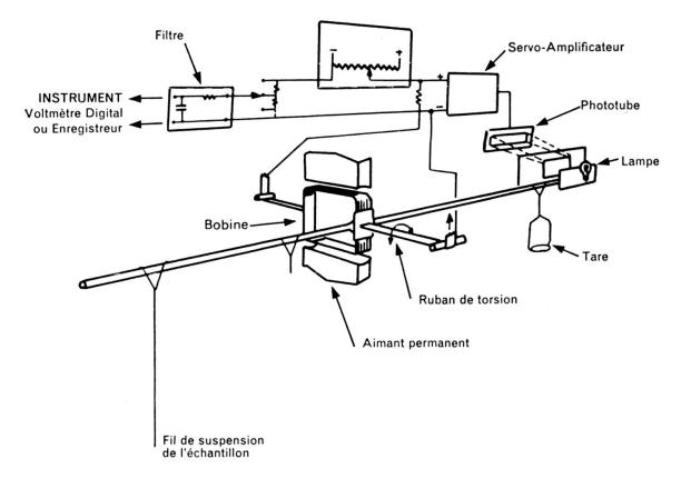
Fig. II.2. — Mécanisme de pesée de la microbalance
